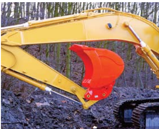
Abb. 2.4 Miller Baggerlöffel und Miller Wechsler
