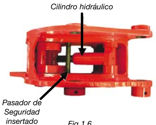
Fig 1.6 Pasador de seguridad del cilindro hidráulico insertado
